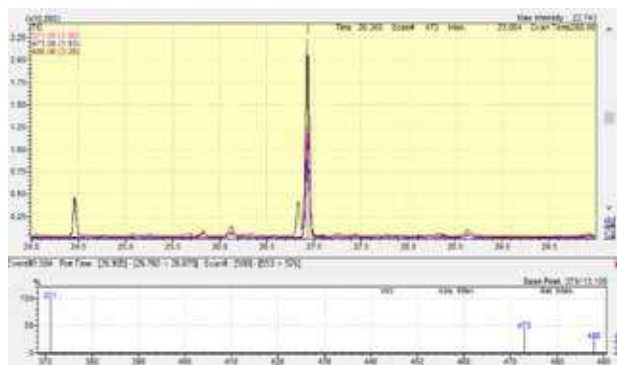
Obr. 9 GC-MS chromatogram a hmotnostní spektrum tetrahydrokanabinol-karboxylové kyseliny v SIM módu
