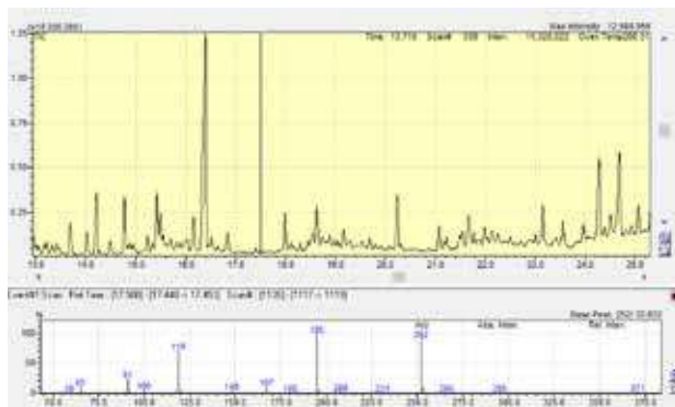
Obr. 8 GC-MS chromatogram a hmotnostní spektrum mefedronu
